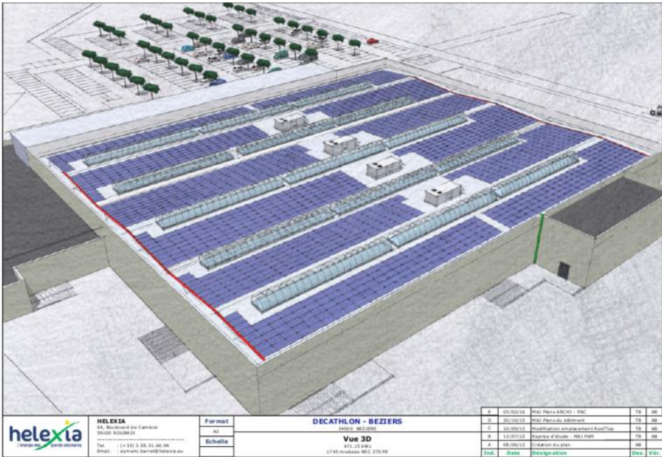
Figure 49 : ENR intégrée au bâtiment – installation d’une centrale photovoltaïque en toiture
