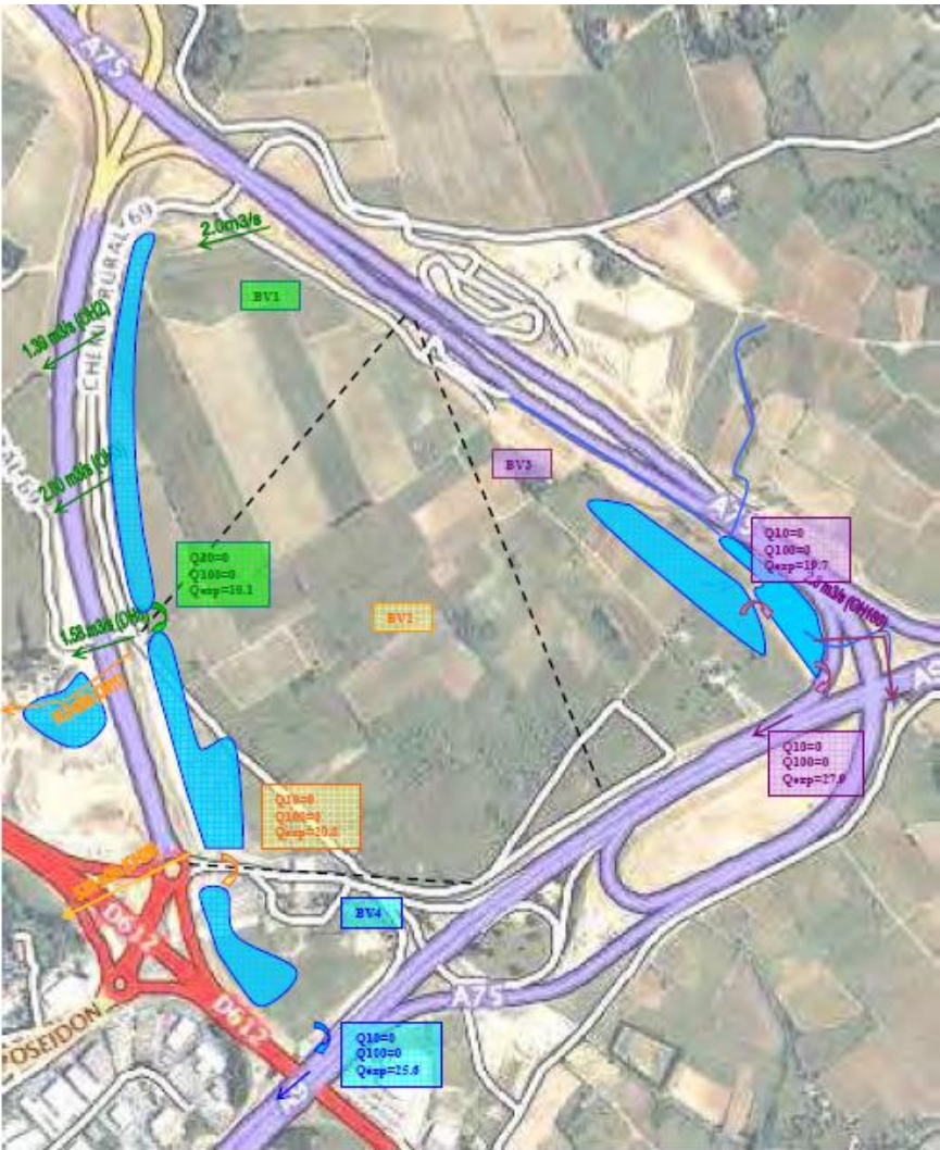
Figure 20 : Aménagements hydrauliques prévus dans le cadre de la ZAC la Méridienne
