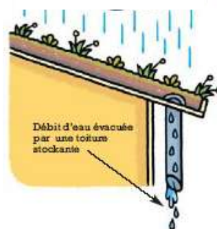
PRINCIPES DES TOITURES STOCKANTES (A GAUCHE ET AU CENTRE) ET VÉGÉTALISÉE (A DROITE)
