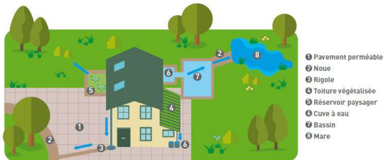
Exemple de différentes techniques alternatives possibles pour gérer les eaux pluviales d'une maison
