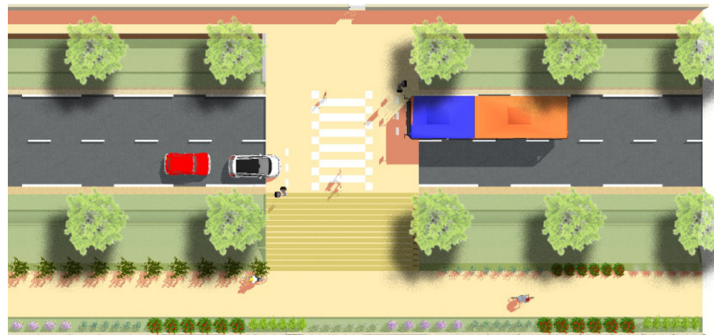
Illustration 5. Vue en plan : traversée sécurisée piétons et cycles - av. Pieree Bérégovoy
